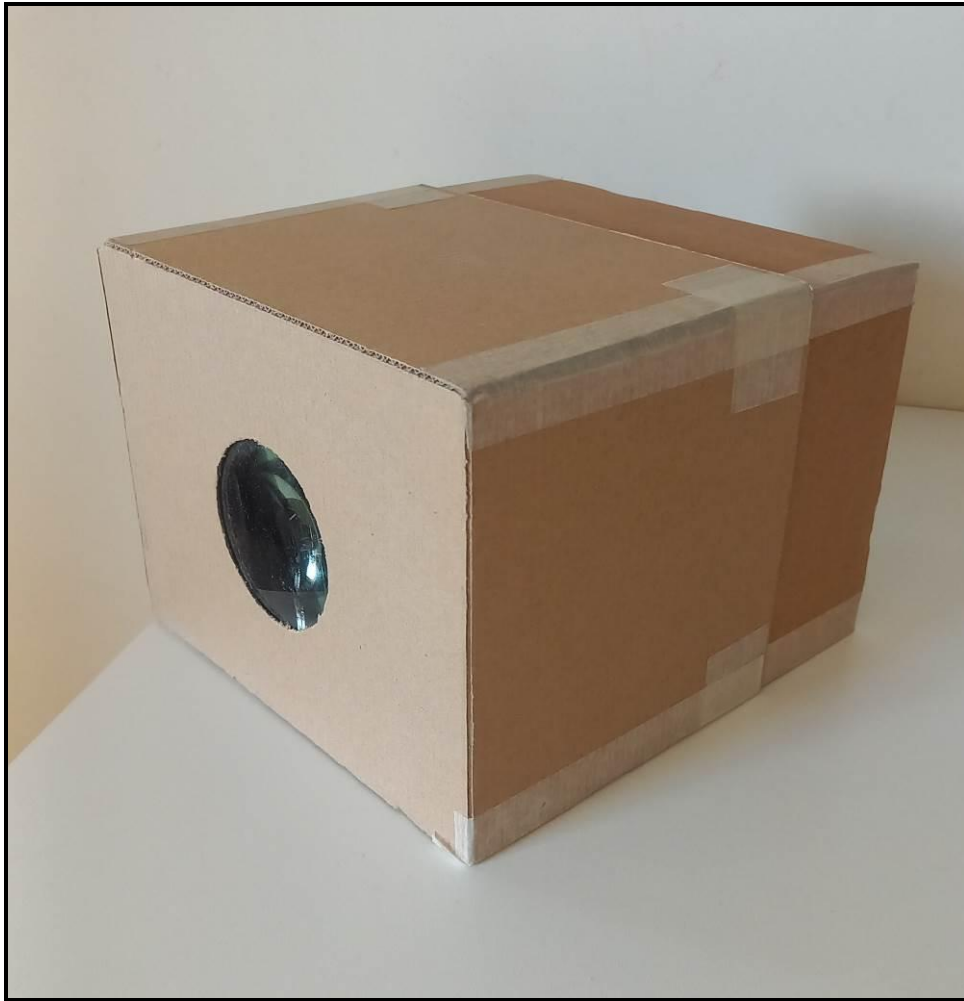
Εικ 1. Η Camera Obscura που έφτιαξαν οι μαθητές. Αποτελείται από χαρτονένιο κουτί ρυθμιζόμενου μήκους για την εστίαση, γυάλινο φακό και ημιδιαφανή επιφάνεια προβολής του ειδώλου στη ράχη του κουτιού.
