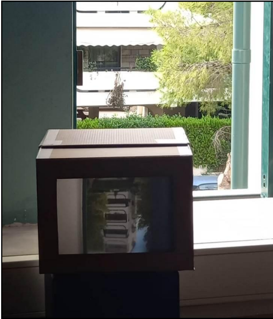
Εικ 2. Η ράχη της κάμερας, όπου προβάλλεται ανεστραμμένο το είδωλο της εικόνας.
